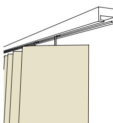
einfache Schiene mit Gleitern Decken- oder Wandmontage
