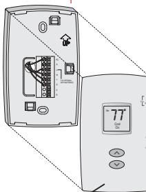
Hale de la parte inferior para quitar el termostato de la placa para pared.
