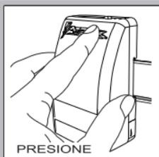
MONTAJE SOBRE RIEL de 35 mm (norma DIN 46277)
