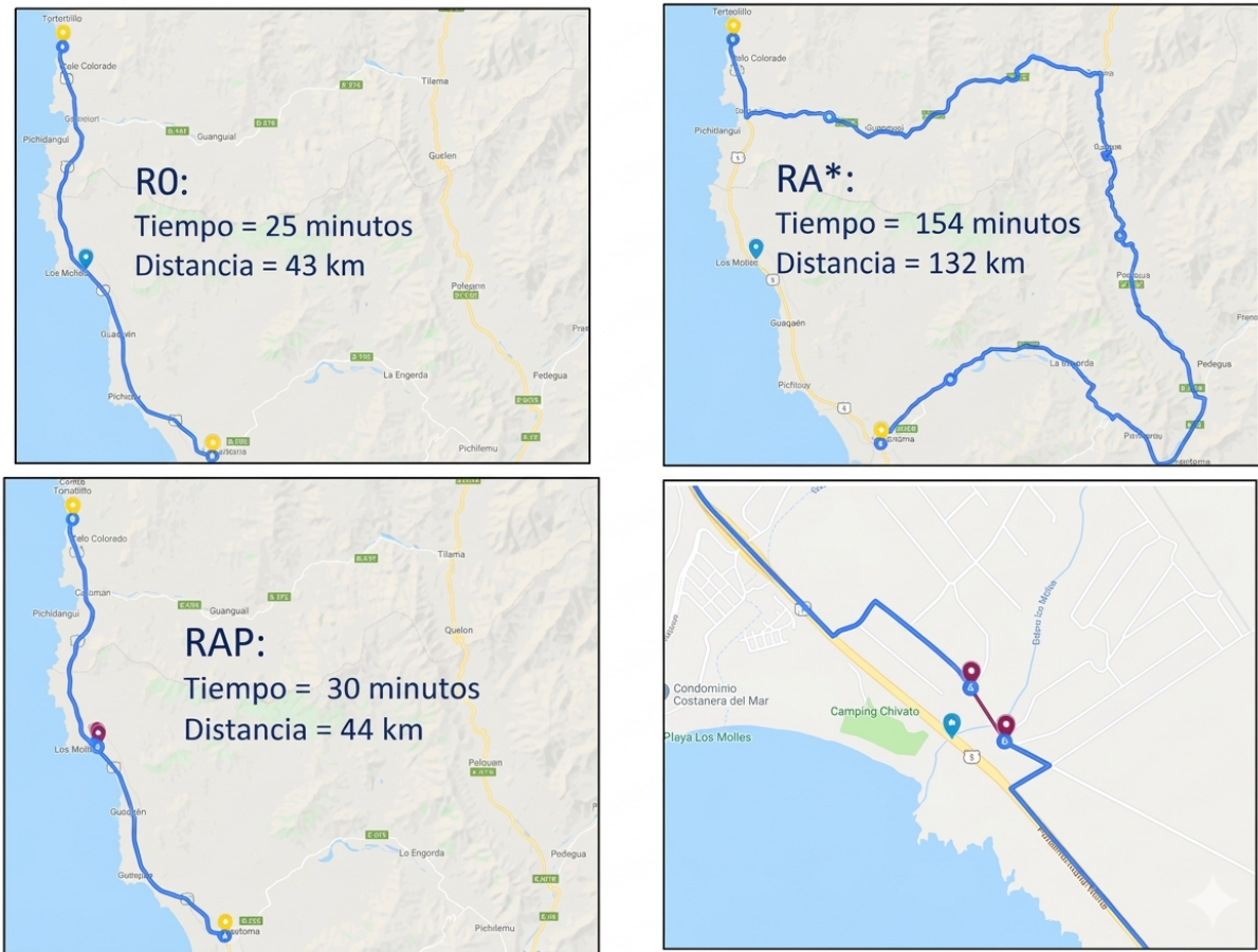
Figura 5. Escenarios de conectividad vial ante falla del Puente Los Molles: ruta normal (R0), alternativa actual (RA*) y alternativa propuesta (RAP)
